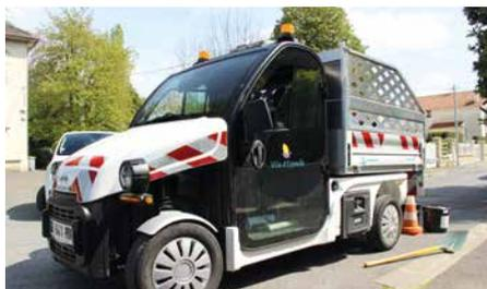
Un deuxième petit véhicule utilitaire électrique est venu rejoindre la flotte automobile de plus en plus «verte» des services techniques. Équipé d'une benne, il est destiné au service de la propreté urbaine.
